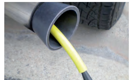
STM 300 pozwala również znaleźć nieszczelności w układzie wydechowym
